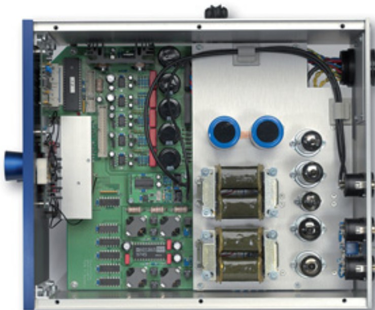
Digital- und Analogabteilung des Players sind strikt getrennt. Links neben dem Röhrenensemble die beiden großzügig dimensionierten Ausgangsübertrager
