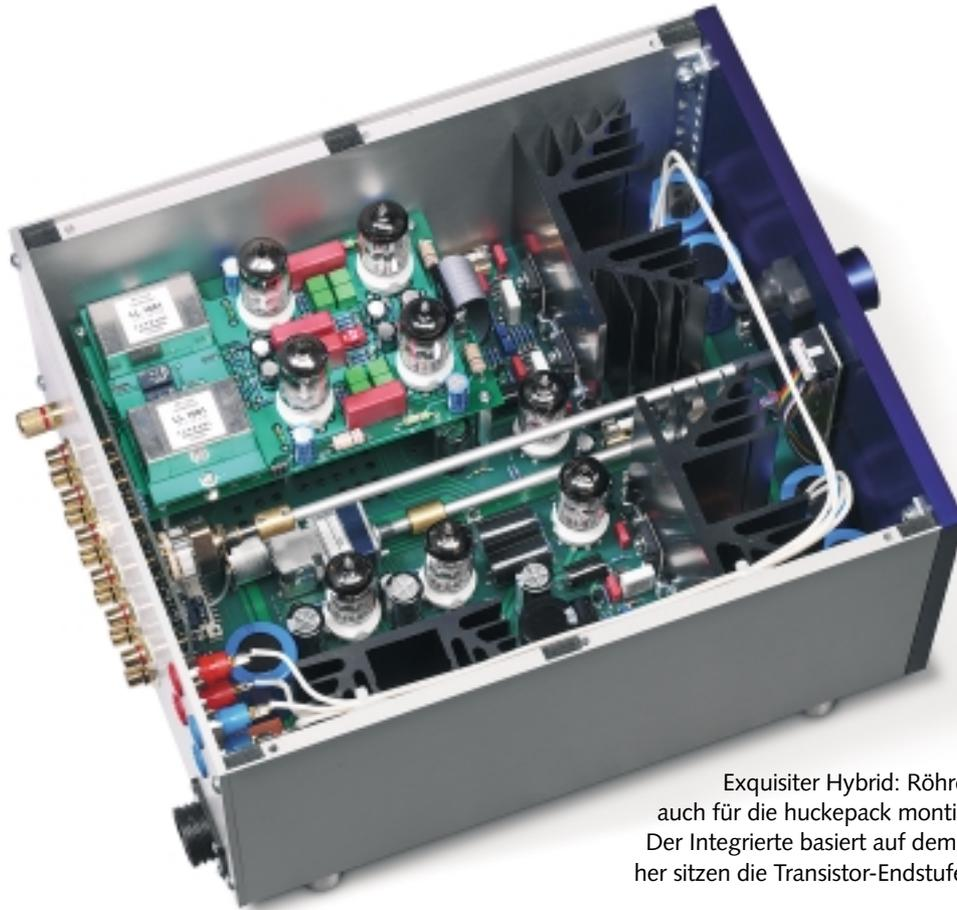
Exquisiter Hybrid: Röhren-Eingangsstufen auch für die huckepack montierte Phonoplatine. Der Integrierte basiert auf dem Vorverstärker, daher sitzen die Transistor-Endstufen hinter der Front
