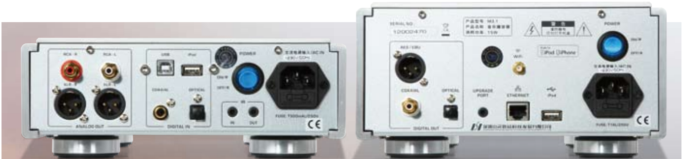
NICHT GANZ KONSEQUENT: Zwischen Laufwerk (rechts) und Wandler (links) bietet sich nur Koax als Datenverbindung an. Eventueller Jitter taucht aber messtechnisch nicht auf, weil der H1.1 alle Eingänge einem Upsampling unterzieht.
