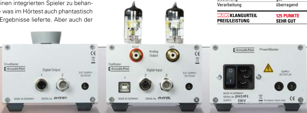
GUTE CONNECTIONS: Der Drive-Master kommuniziert mit dem Digimaster (Mitte) am liebsten über die I2S-Buchse (Nummer 2 am DAC). Das Edelnetzteil PowerMaster (rechts) ist optional und kostet 800 Euro Aufpreis.
